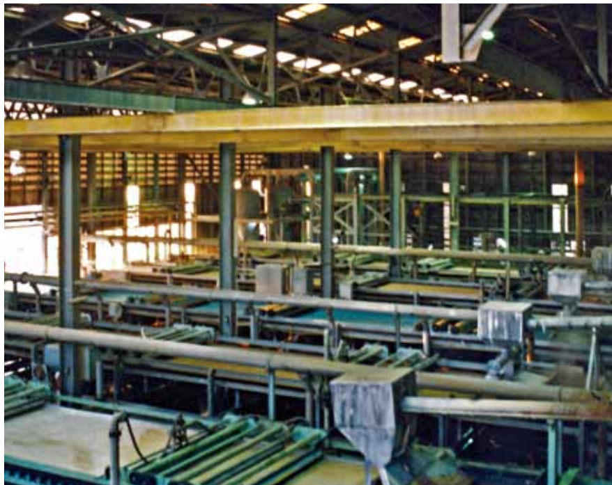
Podciśnieniowy Filtr Pasowy w przemyśle chemicznym
