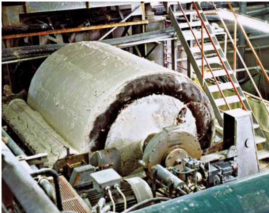
Podciśnieniowy Filtr Bębnowy do odwadniania kaolinu
