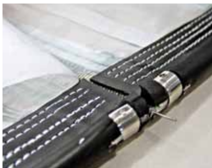
Zamknięcie pasa podciśnieniowego filtra bębnowego ze specjalnym profilem gumowym
