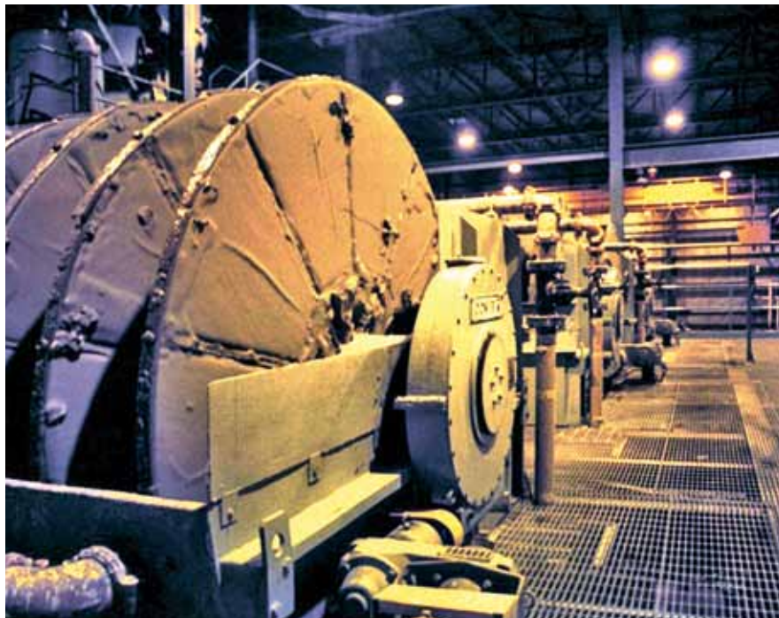
Obrotowy Filtr Tarczowy do odwadniania rudy
